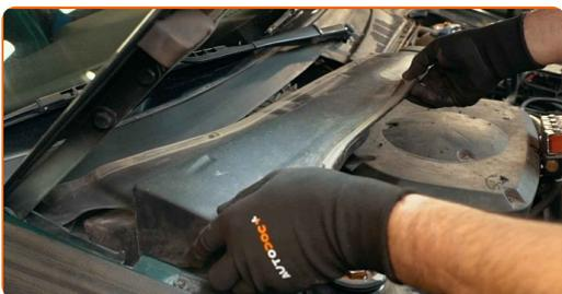
**15** Bauen Sie die Dichtung der Windabweiserabdeckung ein.
