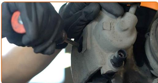
**11** Entfernen Sie den Bremssattel.
