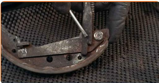
**20** Entfernen Sie den Bremsbackenhebel.
