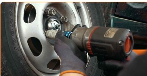
**33** Schrauben Sie die Nabenmutter an. Verwenden Sie Stecknuss Nr. 24. Verwenden Sie einen Ratschenschlüssel.
