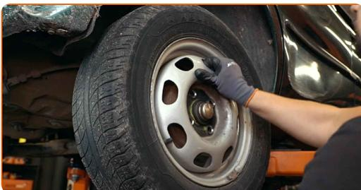
**8** Reinigen Sie die Bremstrommel. Benutzen Sie eine Drahtbürste. Verwenden Sie Allzweckreinigungsspray.
