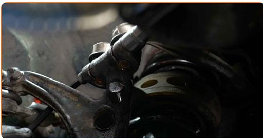
**62** Ziehen Sie die Befestigung des oberen Arms an. Verwenden Sie Stecknuss Nr. 16. Verwenden Sie Inbusschlüssel Nr. H8. Verwenden Sie einen Drehmomentschlüssel. Ziehen Sie ihn mit 40 Nm Drehmoment fest.
