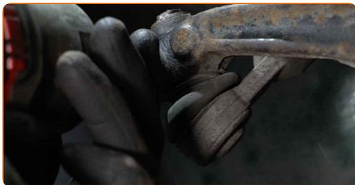
**19** Entfernen Sie die Befestigungsschraube. Verwenden Sie einen Splintentreiber. Benutzen Sie einen Hammer.
