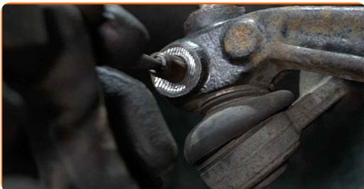
**20** Lockern Sie die Befestigungsschraube des Spurstangenkopfs. Verwenden Sie Ring-Gabelschlüssel Nr. 13.
