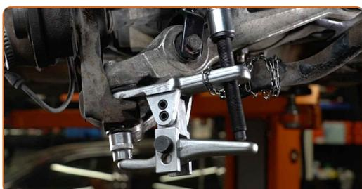
**37** Entfernen Sie die Achsschenkel zusammen mit der Nabe.
