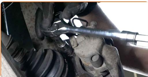
**13** Entfernen Sie die Sattelhalterung.
