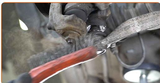
**35** Schrauben Sie die Kugelgelenkbefestigung vom Achsschenkel ab. Verwenden Sie Ring-Gabelschlüssel Nr. 18.
