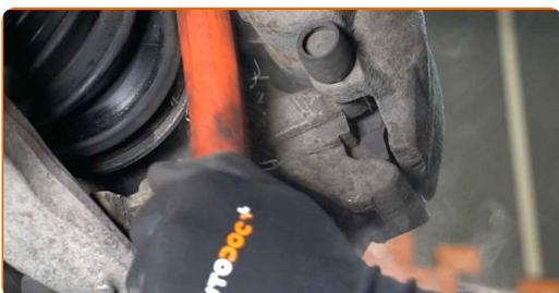
**12** Lösen Sie die Befestigung der Sattelhalterung. Verwenden Sie Stecknuss Nr. 17. Verwenden Sie einen Ratschenschlüssel. Verwenden Sie ein Windeisen.
