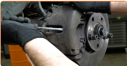
**11** Die Befestigungselemente der Bremssattelhalterung reinigen. Benutzen Sie eine Drahtbürste. Benutzen Sie WD-40-Spray.
