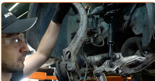
**38** Entfernen Sie die Querlenker.
