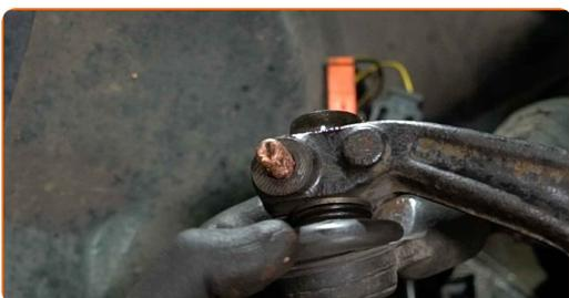
**57** Schrauben Sie die Befestigungsschraube des Spurstangenkopfs ein. Verwenden Sie Ring-Gabelschlüssel Nr. 13.
