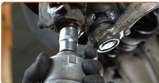
**36** Trennen Sie das Kugelgelenk vom Achsschenkel. Verwenden Sie einen Kugelgelenkabzieher. Benutzen Sie ein Brecheisen.
