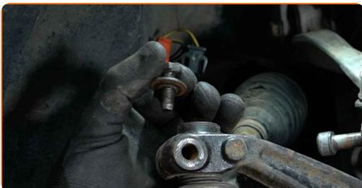
**22** Spreizen Sie die Halterung der Sicherungsschraube auf dem Spurstangenkopf. Verwenden Sie einen flachen Metallmeißel. Benutzen Sie einen Hammer.
