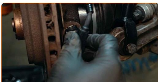
**14** Verbinden Sie das ABS mit der Sensorverdrahtung.
