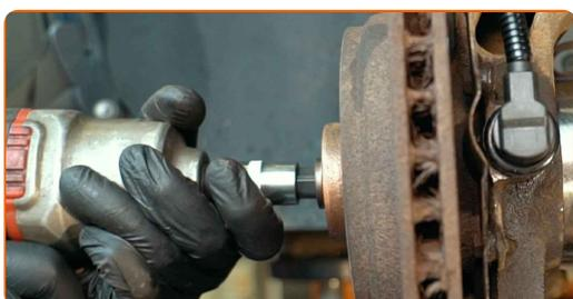
**16** Entfernen Sie die Befestigungsschraube.
