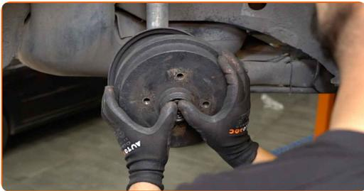
**11** Reinigen Sie den Einbauort für die Nabenlagerung. Verwenden Sie Allzweckreinigungsspray.
