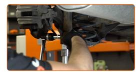
Die Montage unter dem Hinterachsträger entfernen.
