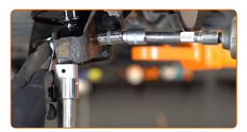
Ziehen Sie den unteren Befestiger des Stoßdämpfers an. Verwenden Sie Ring-Gabelschlüssel Nr. 21. Verwenden Sie Stecknuss Nr. 21. Verwenden Sie einen Drehmomentschlüssel. Ziehen Sie ihn mit 40 Nm Drehmoment fest.+90°
