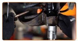
Die Montage unter dem Hinterachsträger entfernen.
