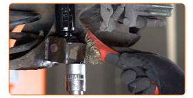
Schrauben Sie den unteren Befestiger des Stoßdämpfers ab. Verwenden Sie Ring-Gabelschlüssel Nr. 21. Verwenden Sie Stecknuss Nr. 21. Verwenden Sie ein Windeisen.
