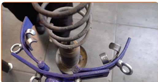
**32** Die Staubkappe des Stoßdämpfers und den Anschlagpuffer entfernen.
