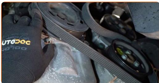
Austausch: Keilriemen – VW New Beetle Schrägheck (9C1, 1C1). Tipp:
