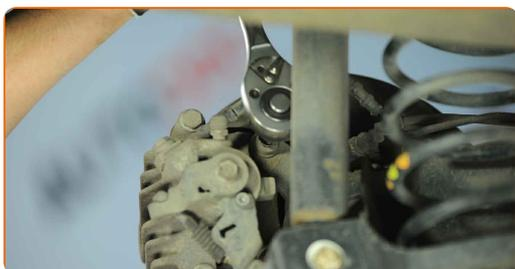
**9** Verteilen Sie die Bremsbeläge. Benutzen Sie ein Brecheisen.
