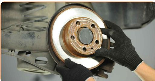
**17** Reinigen Sie die Nabe. Benutzen Sie eine Drahtbürste. Behandeln Sie die Kontaktfläche. Benutzen Sie ein Kupferschmiermittel.
