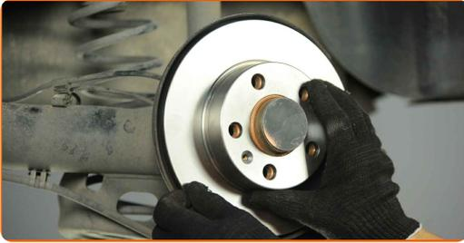
**19** Ziehen Sie die Befestigung der Bremsscheibe fest. Verwenden Sie einen Kreuzschlitzschraubendreher. Verwenden Sie einen Drehmomentschlüssel. Ziehen Sie ihn mit 4 Nm Drehmoment fest.
