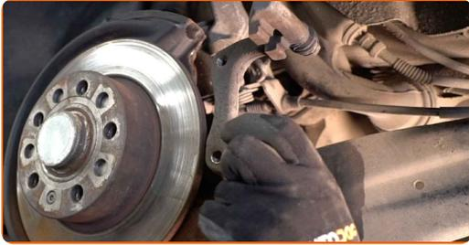
**14** Reinigen Sie die Befestigungselemente der Bremsscheibe. Benutzen Sie eine Drahtbürste. Benutzen Sie WD-40-Spray.
