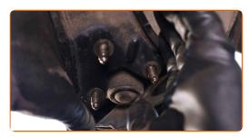
Ziehen Sie die Befestigungen an, die das Kugelgelenk mit dem Achslenker verbinden. Verwenden Sie Stecknuss Nr. 16. Verwenden Sie einen Ratschenschlüssel.
