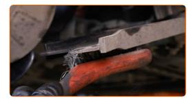
Reinigen Sie die Montagesitze des Federbeins auf dem Achsschenkel. Reinigen Sie den Montagesitz der Antriebswelle. Benutzen Sie eine Drahtbürste. Benutzen Sie WD-40-Spray.
