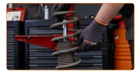
Entfernen Sie die Staubmanschette.
