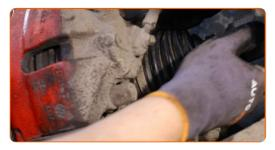
Setzen Sie den Antriebswellenschraube ein und ziehen Sie diese fest. Verwenden Sie die 12-Kant-Stecknuss Nr. 24. Verwenden Sie einen Ratschenschlüssel.
