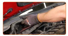
Schrauben Sie die Befestigung der Kunststoffplatte an. Verwenden Sie den Torx T30. Verwenden Sie einen Ratschenschlüssel.
