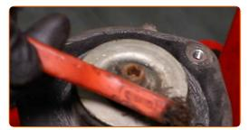
Entfernen Sie die Stangenmutter des Federkolben. Verwenden Sie eine 21 mm Schienenmutterstecknuss. Verwenden Sie Inbusschlüssel Nr. H7. Verwenden Sie einen Ratschenschlüssel.
