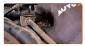
Ziehen Sie die Befestigung an, die die Halterung des Bremsschlauchs mit dem Federbein verbindet. Verwenden Sie Ring-Gabelschlüssel Nr. 10.
