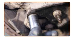
Montieren Sie den Querlenker.
