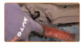
Schrauben Sie die Befestigungen ab, die das Kugelgelenk mit dem Querlenker verbinden. Verwenden Sie Stecknuss Nr. 16. Verwenden Sie einen Ratschenschlüssel.
