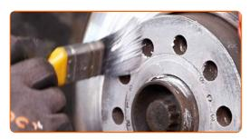
Die Bremsscheibenoberfläche reinigen. Benutzen Sie einen Bremsenreiniger.
