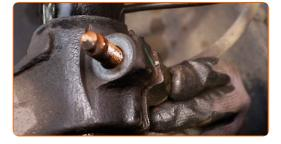
Schrauben Sie das Befestigungselement ein, das das Federbein mit dem Achsschenkel verbindet. Verwenden Sie Stecknuss Nr. 18. Benutzen Sie den XZN #14. Verwenden Sie einen Ratschenschlüssel.
