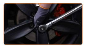
Ziehen Sie die Radschrauben unter Verwendung eines Kreuzmusters an. Verwenden Sie eine Schlagnuss für Felgen # 17. Verwenden Sie einen Drehmomentschlüssel. Ziehen Sie ihn mit 120 Nm Drehmoment fest.
