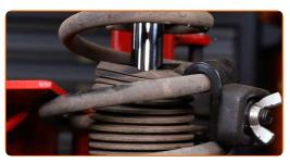
Reinigen Sie die Kolbenstange des Federbeins. Benutzen Sie eine Drahtbürste. Benutzen Sie WD-40-Spray.
