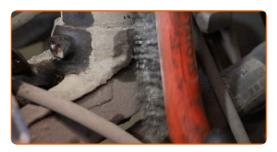
Schrauben Sie das untere Befestigungselement ab, dass das Federbein mit dem Achsschenkel verbindet. Verwenden Sie Stecknuss Nr. 18. Benutzen Sie den XZN #14. Verwenden Sie einen Ratschenschlüssel.
