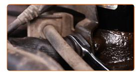
Ziehen Sie die Befestigungsklammer des Bremsschlauchs am Federbein an. Verwenden Sie Stecknuss Nr. 10. Verwenden Sie einen Drehmomentschlüssel. Ziehen Sie ihn mit 12 Nm Drehmoment fest.
