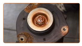
53 Entfernen Sie das zusammengebaute Federbein.
