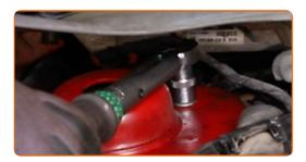
Behandeln Sie die Befestigungselemente des Federbeinstützlagers. Benutzen Sie ein Kupferschmiermittel.
