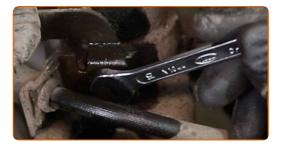
Entfernen Sie die Halterung des Bremsschlauchs.
