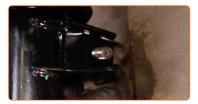
Ziehen Sie die Befestigungselemente des Stabilenkers fest. Verwenden Sie Stecknuss Nr. 18. Benutzen Sie den XZN #6. Verwenden Sie einen Ratschenschlüssel.
