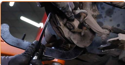
**32** Lösen Sie das untere Befestigungselement, dass das Federbein mit dem Achsschenkel verbindet. Verwenden Sie eine spezielle Schraubnuss, um den Stoßdämpfer zu entfernen.
