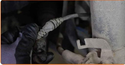
**19** Reinigen Sie die Befestigung, die die Halterung des Bremsschlauchs mit dem Federbein verbindet. Benutzen Sie eine Drahtbürste. Benutzen Sie WD-40-Spray.
