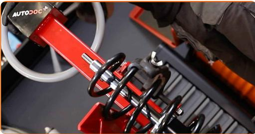
**46** Installieren Sie die Staubmanschette.
