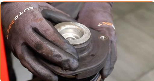
**48** Ziehen Sie die Federbeinkolbenstangenmutter an. Verwenden Sie eine 21 mm Schienenmutterstecknuss. Verwenden Sie Inbusschlüssel Nr. H6. Verwenden Sie einen Drehmomentschlüssel. Ziehen Sie ihn mit 60 Nm Drehmoment fest.
