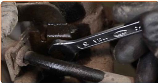
**21** Entfernen Sie die Halterung des Bremsschlauchs.
