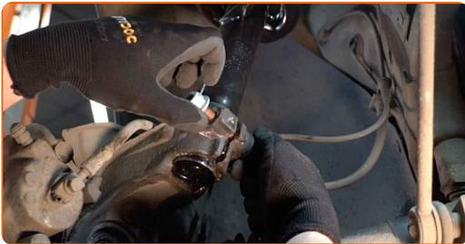
52 Ziehen Sie die unteren Befestigungen an, die das Federbein mit dem Achsschenkel verbinden. Verwenden Sie Stecknuss Nr. 18. Benutzen Sie den XZN #12. Verwenden Sie einen Ratschenschlüssel.
