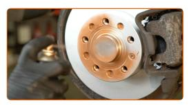
Die Bremsscheibenoberfläche reinigen. Benutzen Sie einen Bremsenreiniger.
