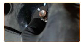
Drehe die Schraube ein, die den Querlenker mit dem Hilfsrahmen verbindet. Verwenden Sie Stecknuss Nr. 18. Verwenden Sie einen Ratschenschlüssel.
