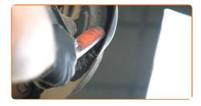
Drehen Sie Befestigungselement auf, das den Querlenker mit dem hinteren Achsschenkel verbindet. Verwenden Sie Ring-Gabelschlüssel Nr. 18 (2 Teile).
