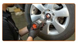
Senken Sie das Auto und ziehen Sie die Radschrauben über Kreuz an. Verwenden Sie eine Schlagnuss für Felgen 36 # 17. Verwenden Sie einen Drehmomentschlüssel. Ziehen Sie ihn mit 120 Nm Drehmoment fest.
