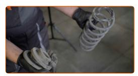
Reinigen Sie die Aufnahmen der Spiralfedern. Benutzen Sie eine Drahtbürste. Benutzen Sie WD-40-Spray.
