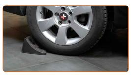
Lösen Sie die Radhalterungsschrauben. Verwenden Sie eine Schlagnuss für Felgen # 17.
