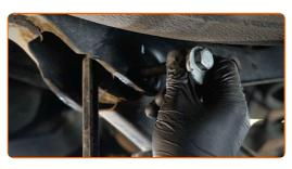
Entfernen Sie den Träger unter dem Arm. Benutzen Sie ein Brecheisen.
