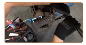
Entfernen Sie den Bremssattel.
