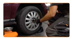
Entfernen Sie den Wagenheber sowie die Unterlegkeile.
