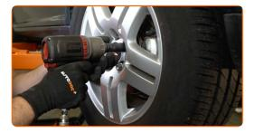
Senken Sie das Auto und ziehen Sie die Radschrauben über Kreuz an. Verwenden Sie eine Schlagnuss für Felgen # 17. Verwenden Sie einen Drehmomentschlüssel. Ziehen Sie ihn mit 120 Nm Drehmoment fest.
