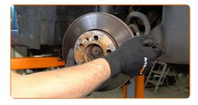
Lösen Sie den ABS-Sensor. Verwenden Sie einen Splintentreiber. Benutzen Sie einen Hammer. Benutzen Sie ein Brecheisen.
