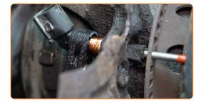
Reinigen Sie den Befestigungssitz des ABS-Sensors. Benutzen Sie eine Drahtbürste. Benutzen Sie WD-40-Spray.
