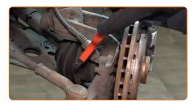
Trennen Sie den Stecker des ABS-Sensors. Verwenden Sie einen flachen Schraubendreher.
