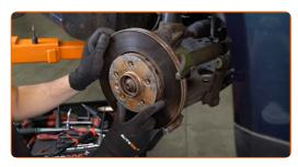
Ziehen Sie die Befestigung der Bremsscheibe fest. Verwenden Sie den Torx T30. Verwenden Sie einen Drehmomentschlüssel. Ziehen Sie ihn mit 6 Nm Drehmoment fest.
