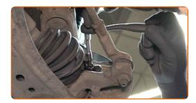
Entfernen Sie die Kappen der Führungsbolzenmanschetten des Bremssattels. Benutzen Sie ein Brecheisen.
