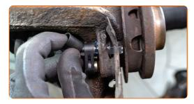
Schrauben Sie die Befestigung, die den ABS-Sensor am Achsschenkel verbindet, fest. Verwenden Sie Inbusschlüssel Nr. H5. Verwenden Sie einen Drehmomentschlüssel. Ziehen Sie ihn mit 6 Nm Drehmoment fest.
