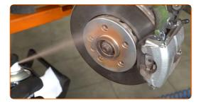
Die Bremsscheibenoberfläche reinigen. Benutzen Sie einen Bremsenreiniger.
