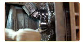
Schrauben Sie die Befestigung des Bremssattels ab. Verwenden Sie Inbusschlüssel Nr. H7. Verwenden Sie einen Ratschenschlüssel. Verwenden Sie ein Windeisen.
