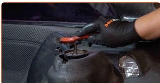
**3** Lösen Sie die oberen Befestigungselemente des Federbeinstützlagers. Verwenden Sie Ring-Gabelschlüssel Nr. 17. Verwenden Sie einen Stoßdämpfer Steckschlüsseleinsatz DDN<sup>®</sup>6. Verwenden Sie einen Ratschenschlüssel.
