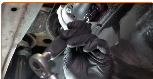
**14** Bringen Sie den Kühlmittelschlauch an.
