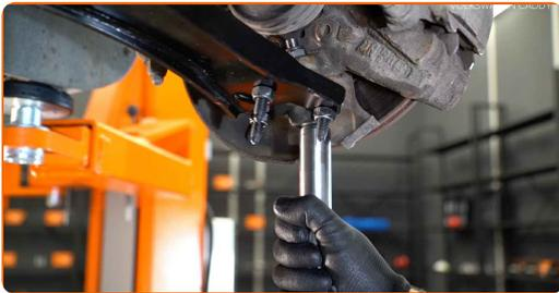
18 Schrauben Sie die vordere Armbefestigung an. Verwenden Sie Stecknuss Nr. 18 oder Ringschlüssel Nr. 18. Ziehen Sie ihn mit 70 Nm Drehmoment fest.+90°
