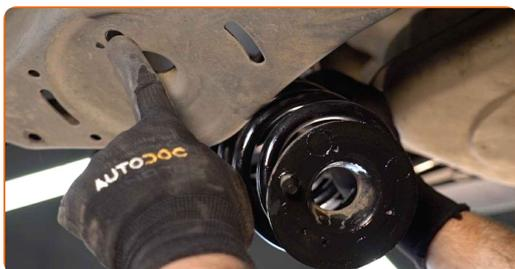
**17** Bauen Sie die Spiralfeder zusammen mit den Gummilager in deren Aufnahmen ein.
