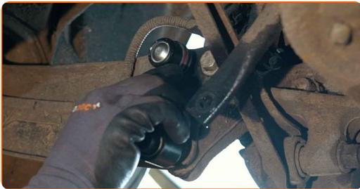
**14** Ziehen Sie die Befestigungselemente des Stabilenkers fest. Verwenden Sie Ring-Gabelschlüssel Nr. 16. Benutzen Sie den XZN #6. Verwenden Sie einen Ratschenschlüssel.
