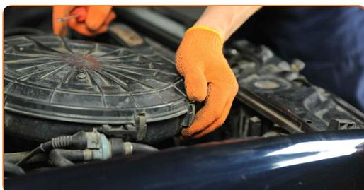
**5** Entfernen Sie die Abdeckung des Luftfilters.
