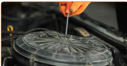
**4** Lösen Sie die Befestigungsclips der Luftfilterabdeckung.
