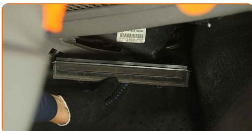
**8** Schrauben Sie die Verbindungselemente der Innenfilter-Gehäuseabdeckung ein. Verwenden Sie Stecknuss Nr. 7. Verwenden Sie einen Ratschenschlüssel.
