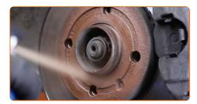
Die Bremsscheibenoberfläche reinigen. Benutzen Sie einen Bremsenreiniger.
