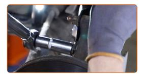
Entfernen Sie den Träger unter dem Achsschenkel.
