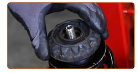
Ziehen Sie die Federbeinkolbenstangenmutter an. Verwenden Sie Inbusschlüssel Nr. H7. Verwenden Sie eine 21 mm Schienenmutterstecknuss. Verwenden Sie einen Drehmomentschlüssel. Ziehen Sie ihn mit 60 Nm Drehmoment fest.
