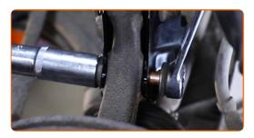
Ziehen Sie die unteren Befestigungen an, die das Federbein mit dem Achsschenkel verbinden. Verwenden Sie Ring-Gabelschlüssel Nr. 18. Verwenden Sie Stecknuss Nr. 18. Verwenden Sie einen Drehmomentschlüssel. Ziehen Sie ihn mit 40 Nm Drehmoment fest. +90°
