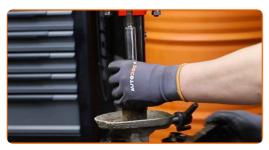
Setzen Sie einen neuen Stoßdämpfer in den hydraulischen Federspanner ein.
