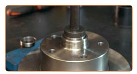
Behandeln Sie das Radnabenlager. Verwenden Sie Mehrzweckfett.
