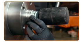
Entfernen Sie Schmutz und Staub vom Bremssattelhalter. Benutzen Sie eine Drahtbürste. Benutzen Sie einen Bremsenreiniger.
