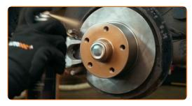
Die Bremsscheibenoberfläche reinigen. Benutzen Sie einen Bremsenreiniger.
