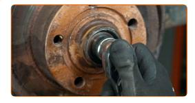
Entfernen Sie die mit der Radnabenlagerung zusammengebaute Bremsscheibe. Benutzen Sie ein Brecheisen.
