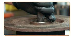
Entfernen Sie den Innenring des Lagers von der Radnabe. Entfernen Sie den inneren Dichtring des Radlagers. Verwenden Sie einen Universalabzieher. Verwenden Sie den Schlaghammer-Nabenabzieher.
