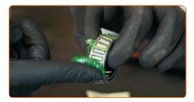
Drücken Sie den inneren Dichtring des Radlagers ein. Verwenden Sie einen Druckstücksatz mit Ein-/Auspresswerkzeug. Benutzen Sie einen Hammer.
