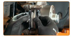
Installieren Sie den Bremssattel und fixieren Sie diesen. Verwenden Sie Ring-Gabelschlüssel Nr. 15. Verwenden Sie Stecknuss Nr. 13. Verwenden Sie einen Drehmomentschlüssel. Ziehen Sie ihn mit 35 Nm Drehmoment fest.
