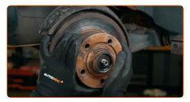
Reinigen Sie den Achsschenkel. Benutzen Sie eine Drahtbürste. Verwenden Sie Allzweckreinigungsspray.
