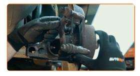
Reinigen Sie die Bremsscheibenbefestigung. Benutzen Sie eine Drahtbürste. Benutzen Sie WD-40-Spray.
