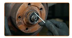
Schrauben Sie die Nabenmutter ab. Verwenden Sie Stecknuss Nr. 24. Verwenden Sie ein Windeisen.
