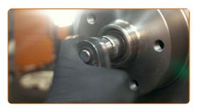
30 Sichern Sie die Nabenmutter mit einem neuen Splint. Benutzen Sie einen Hammer. Benutzen Sie ein Brecheisen.
