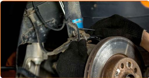
**10** Entfernen Sie die Staubschutzkappen der Bremssattel-Führungsstifte. Verwenden Sie einen flachen Schraubendreher.
