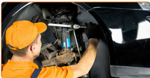
**21.2** Verwenden Sie Ring-Gabelschlüssel Nr. 19. Verwenden Sie Inbusschlüssel Nr. H5. Verwenden Sie einen Ratschenschlüssel.
