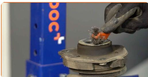
**33** Entfernen Sie die Stangenmutter des Federkolben. Verwenden Sie Stecknuss Nr. 21. Verwenden Sie Inbusschlüssel Nr. H6. Verwenden Sie einen Ratschenschlüssel.
