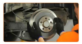
Ziehen Sie die Halteklammern der Bremstrommeln an. Verwenden Sie den Torx T30. Verwenden Sie einen Drehmomentschlüssel. Ziehen Sie ihn mit 4 Nm Drehmoment fest.
