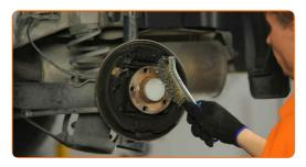
10 Installieren Sie eine Bremstrommel.
