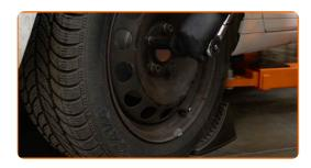
Entfernen Sie den Wagenheber sowie die Unterlegkeile.
