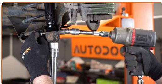
**29** Ziehen Sie die obere Stoßdämpferbefestigung an. Verwenden Sie Ring-Gabelschlüssel Nr. 16. Verwenden Sie Stecknuss Nr. 16. Verwenden Sie einen Drehmomentschlüssel. Ziehen Sie ihn mit 30 Nm Drehmoment fest.+90°
