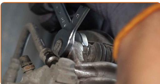
**10** Entfernen Sie die Befestigungsschrauben.
