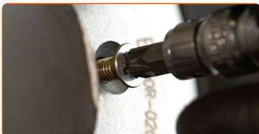
**37** Schrauben Sie die Befestigungen der Bremsscheibe fest. Verwenden Sie einen Kreuzschlitzschraubendreher. Verwenden Sie einen Drehmomentschlüssel. Ziehen Sie ihn mit 4 Nm Drehmoment fest.
