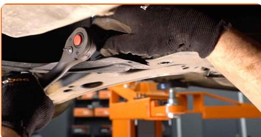
**13** Entfernen Sie die vordere Befestigung des Querlenkers.
