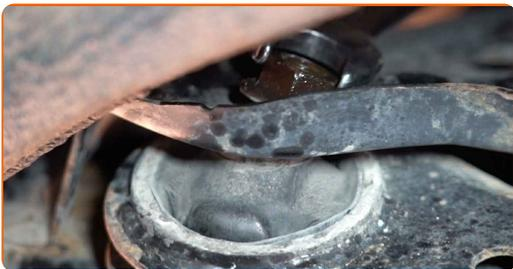
**12** Schrauben Sie die vordere Armbefestigung ab. Verwenden Sie Stecknuss Nr. 18. Verwenden Sie einen Ratschenschlüssel.
