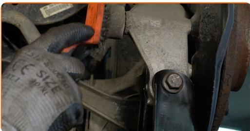
**15** Reinigen Sie die Stoßdämpferbefestigungen. Benutzen Sie eine Drahtbürste. Benutzen Sie WD-40-Spray.
