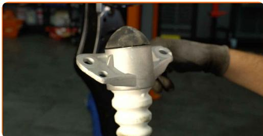
**33** Reinigen Sie die Stoßdämpferaufnahmen. Benutzen Sie eine Drahtbürste. Benutzen Sie WD-40-Spray.
