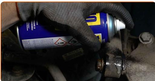
**16** Schrauben Sie den unteren Befestigungen des Stoßdämpfers ab. Verwenden Sie Stecknuss Nr. 21. Verwenden Sie einen Ratschenschlüssel.
