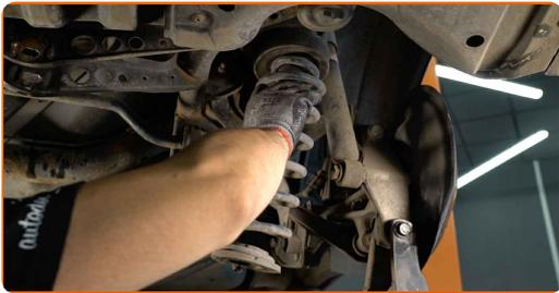
**14** Reinigen Sie die Montagebohrungen und die Gewinde des Querlenkers. Benutzen Sie eine Drahtbürste. Benutzen Sie WD-40-Spray.
