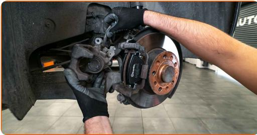
Austausch: Bremsbeläge – VW Beetle Schrägheck (5C1, 5C2). Fachleute empfehlen:
