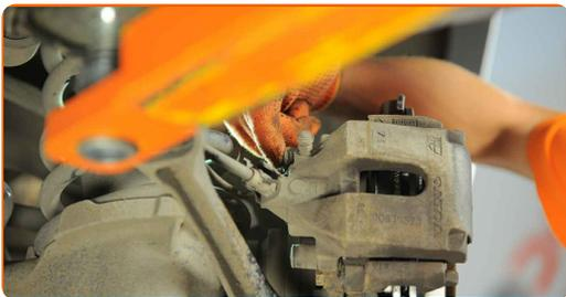
**21** Bauen Sie die Bremssattel-Haltefeder ein. Verwenden Sie einen flachen Schraubendreher.
