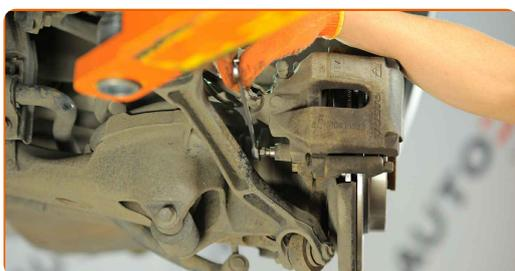
**20** Installieren Sie die Staubschutzkappen der Bremssattel-Führungsstifte.
