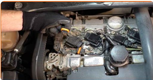
**6** Ziehen Sie die Lufteinlassrohrbefestigung ab. Verwenden Sie Stecknuss Nr. 10. Verwenden Sie einen Ratschenschlüssel.
