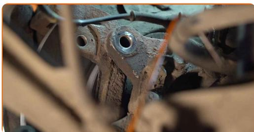
**24** Befestigen Sie die Bremssattelhalterung. Verwenden Sie Stecknuss Nr. 13. Verwenden Sie einen Drehmomentschlüssel. Ziehen Sie ihn mit 60 Nm Drehmoment fest.
