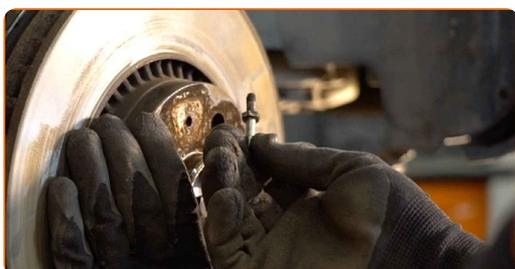
**18** Entfernen Sie die Bremsscheibe.
