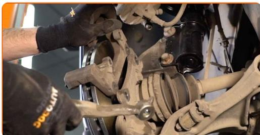
**24** Befestigen Sie die Bremssattelhalterung. Verwenden Sie Stecknuss Nr. 15. Verwenden Sie einen Drehmomentschlüssel. Ziehen Sie ihn mit 100 Nm Drehmoment fest.
