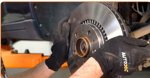
**21** Ziehen Sie die Befestigung der Bremsscheibe fest. Verwenden Sie Stecknuss Nr. 10. Verwenden Sie einen Drehmomentschlüssel. Ziehen Sie ihn mit 9 Nm Drehmoment fest.
