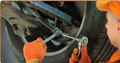
**4** Drehen Sie das Befestigungselement auf, das die Koppelstange mit dem Querlenker verbindet. Verwenden Sie Ring-Gabelschlüssel Nr. 18. Verwenden Sie den Torx T40. Verwenden Sie einen Ratschenschlüssel.
