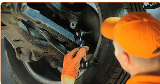
**9** Ziehen Sie das Befestigungselement an, das die Druckstange mit dem Stabilisator verbindet. Verwenden Sie Ring-Gabelschlüssel Nr. 18. Verwenden Sie den Torx T40. Verwenden Sie einen Drehmomentschlüssel. Ziehen Sie ihn mit 50 Nm Drehmoment fest.
