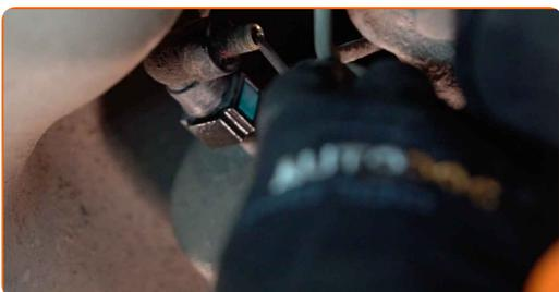
**9** Drücken Sie die Clips zusammen und lösen Sie die Kraftstoffzufuhrleitungen vom Kraftstofffiltergehäuse. Verwenden Sie Kraftstoffleitungsanzangen. Benutzen Sie ein Brecheisen.
