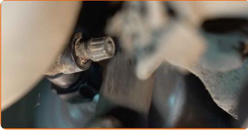
**20** Den Flüssigkeitsbehälter unter dem Kraftstofffilter entfernen.
