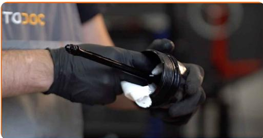
**15** Entfernen Sie die alten O-Ringe aus dem Ölfilterdeckel. Verwenden Sie einen flachen Schraubendreher.
