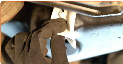
**6** Schrauben Sie die neue Ablassschraube ein und ziehen Sie sie fest. Verwenden Sie Stecknuss Nr. 13. Verwenden Sie einen Drehmomentschlüssel. Ziehen Sie ihn mit 30 Nm Drehmoment fest.
