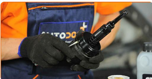
**16** Montieren Sie neue O-Ringe. Verwenden Sie einen flachen Schraubendreher.
