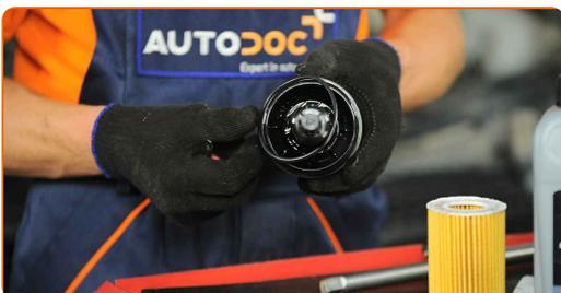
**17** Setzen Sie den neuen Ölfilter in den Montagesitz auf der Filterabdeckung ein.
