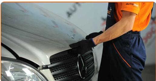
**10** Verwenden Sie eine Kotflügel-Schutzabdeckung, um Schäden an der Lackierung und den Kunststoffteilen des Autos zu verhindern.
