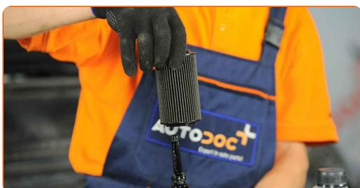
**14** Reinigen Sie den Deckel des Ölfilter-Gehäuses. Verwenden Sie Allzweckreinigungsspray.
