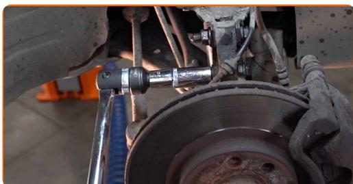
**17** Entfernen Sie die Befestigungsschraube.
