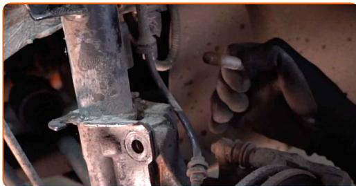
**18** Stützen Sie die Achsschenkel auf. Benutzen Sie einen hydraulischen Getriebeheber.
