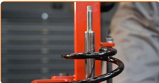
**33** Bringen Sie das Stützlager, die Manschette und den Anschlagpuffer auf dem Stoßdämpfer an.
