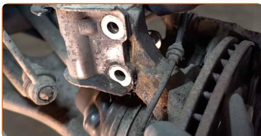
**20** Ziehen Sie den Achsschenkel vom Dämpferbein ab. Benutzen Sie ein Brecheisen.
