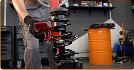
**36** Entfernen Sie das zusammengebaute Federbein.
