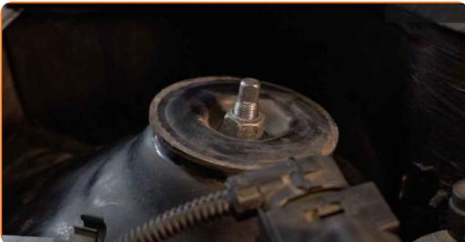
**4** Behandeln Sie die Federbeinstange. Benutzen Sie eine Drahtbürste. Benutzen Sie WD-40-Spray.
