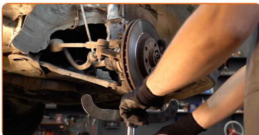
**19** Entfernen Sie die Befestigungsschraube.
