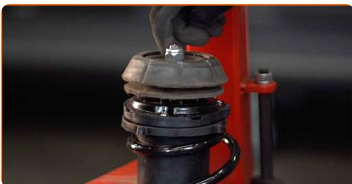
**34** Ziehen Sie die Federbeinkolbenstangenmutter an. Verwenden Sie Stecknuss Nr. 19. Verwenden Sie einen Stoßdämpfer Steckschlüsseleinsatz DDN<sup>®</sup>8. Verwenden Sie einen Drehmomentschlüssel. Ziehen Sie ihn mit 55 Nm Drehmoment fest.
