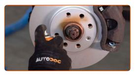
Die Bremsscheibenoberfläche reinigen. Benutzen Sie einen Bremsenreiniger.
