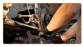
Entfernen Sie die Befestigungsschraube.
