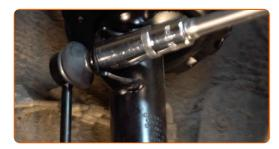
Ziehen Sie die unteren Befestigungen an, die das Federbein mit dem Achsschenkel verbinden. Verwenden Sie Ring-Gabelschlüssel Nr. 18. Verwenden Sie einen Drehmomentschlüssel. Ziehen Sie ihn mit 80 Nm Drehmoment fest.+60°
