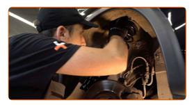
36 Schrauben Sie die obere Befestigung des Domlagers an. Schrauben Sie diese nicht fest.
