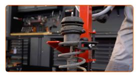
Entfernen Sie die Stangenmutter des Federkolben. Verwenden Sie Stecknuss Nr. 19. Verwenden Sie einen Stoßdämpfer Steckschlüsseleinsatz DDNº8. Verwenden Sie einen Ratschenschlüssel.
