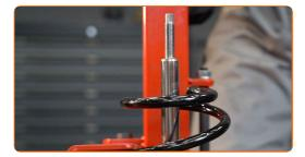
Bringen Sie das Stützlager, die Manschette und den Anschlagpuffer auf dem Stoßdämpfer an.
