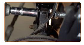
Entfernen Sie den Träger unter dem Achsschenkel.
