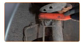
Schrauben Sie das Befestigungselement heraus, das die Druckstange mit dem Federbein verbindet. Verwenden Sie Ring-Gabelschlüssel Nr. 18. Verwenden Sie Stecknuss Nr. 8. Verwenden Sie einen Ratschenschlüssel.
