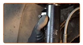
Ziehen Sie das Befestigungselement an, das die Druckstange mit dem Federbein verbindet. Verwenden Sie Ring-Gabelschlüssel Nr. 18. Verwenden Sie Stecknuss Nr. 8. Verwenden Sie einen Drehmomentschlüssel. Ziehen Sie ihn mit 60 Nm Drehmoment fest.
