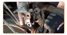
Lösen Sie die obere Befestigung des Domlagers.
