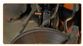
Schrauben Sie das Befestigungselement ein, das das Federbein mit dem Achsschenkel verbindet. Verwenden Sie Ring-Gabelschlüssel Nr. 18. Verwenden Sie Stecknuss Nr. 18.
