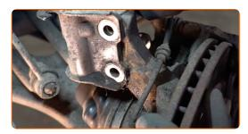
Ziehen Sie den Achsschenkel vom Dämpferbein ab. Benutzen Sie ein Brecheisen.
