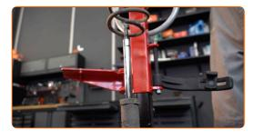
Installieren Sie die Feder am Stoßdämpfer.
