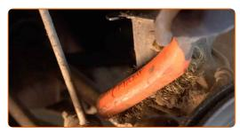
Ziehen Sie den Verschluss des ABS-Sensorkabels von der Stoßdämpferstrebe ab.
