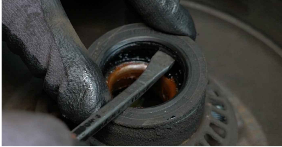
13 Entfernen Sie das Radnabenlager. Benutzen Sie ein Brecheisen.
