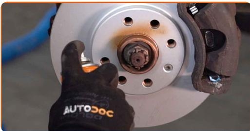
**49** Die Bremsscheibenoberfläche reinigen. Benutzen Sie einen Bremsenreiniger.
