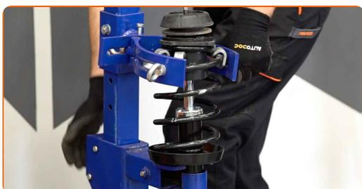
**33** Entfernen Sie das zusammengebaute Federbein.
