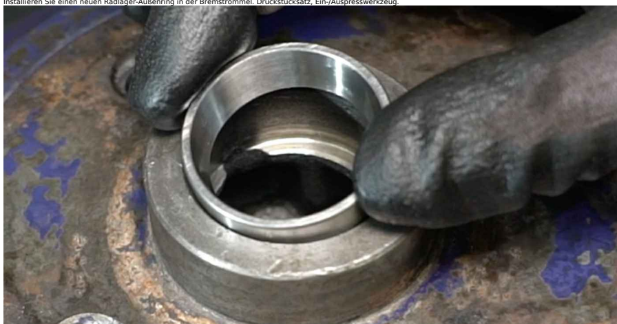
19 Setzen Sie den neuen Innenring des Radlagers in die Bremstrommel ein. Druckstücksatz, Ein-/Auspresswerkzeug.
