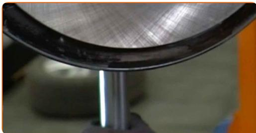
**27** Ziehen Sie den unteren Befestiger des Stoßdämpfers an. Verwenden Sie Stecknuss Nr. E20. Verwenden Sie einen Drehmomentschlüssel. Ziehen Sie ihn mit 130 Nm Drehmoment fest.
