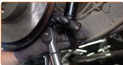
**28** Die Montage unter dem Hinterachsträger entfernen.
