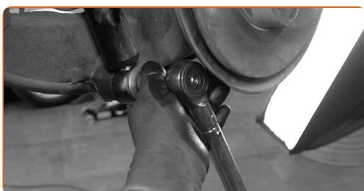
**23** Die Montage unter dem Hinterachsträger entfernen.
