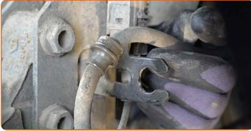
**14** Trennen Sie die ABS Sensorverdrahtung.
