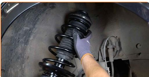
**40** Befestigen Sie das Dämpferbein auf dem Achsschenkel.
