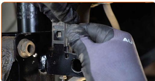
**47** Befestigen Sie den Bremsschlauch an der Strebe.
