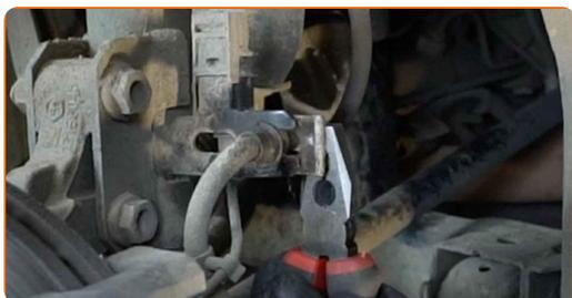
**13** Lösen Sie den Bremsschlauch vom Federbein.
