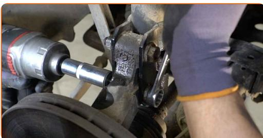
**17** Stützen Sie die Achsschenkel auf. Benutzen Sie einen hydraulischen Getriebeheber.
