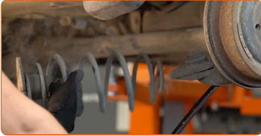
**12** Reinigen Sie die Aufnahmen der Spiralfedern.
