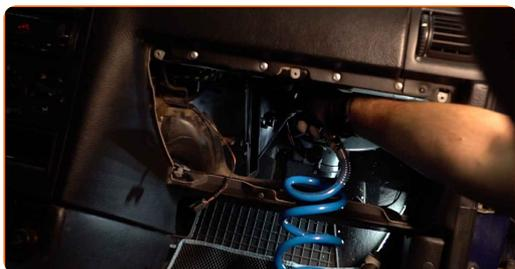
**10** Installieren Sie den Kabinenfilter an seinem Montagesitz.
