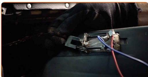
**6** Schrauben Sie die Verbindungselemente der Innenfilter-Gehäuseabdeckung ab. Verwenden Sie Stecknuss Nr. 7.
