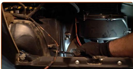
**7** Entfernen Sie die Kabinenfilterabdeckung.
