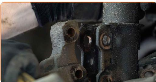
**15** Schrauben Sie die untere Befestigung der Stoßdämpferstrebe ab. Verwenden Sie Ring-Gabelschlüssel Nr. 19. Verwenden Sie Stecknuss Nr. 9. Verwenden Sie einen Ratschenschlüssel.
