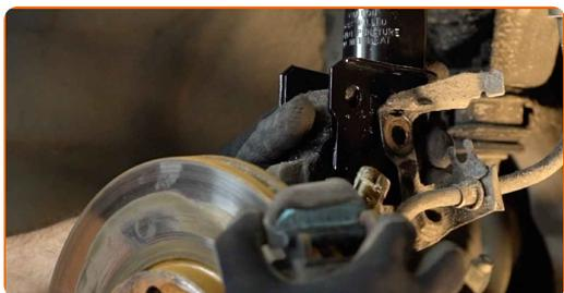
**33** Befestigen Sie den Bremsschlauch an der Strebe.
