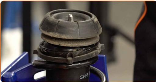
**26** Ziehen Sie die Federbeinkolbenstangenmutter an. Verwenden Sie Ring-Gabelschlüssel Nr. 19. Verwenden Sie Stecknuss Nr. 9. Verwenden Sie einen Drehmomentschlüssel. Ziehen Sie ihn mit 50 Nm Drehmoment fest.
