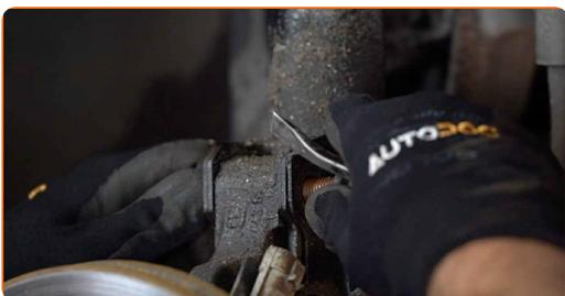
**13** Trennen Sie den Bremsschlauchhalter vom Dämpferbein. Benutzen Sie ein Brecheisen.
