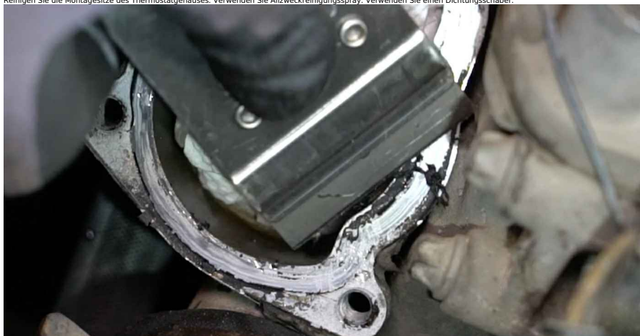
25 Installieren Sie das Thermostatgehäuse zusammen mit dem Thermostat.
